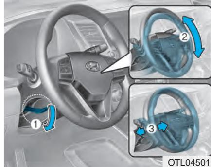
Ziehen Sie den Arretierhebel (1) an der Lenksäule nach unten und stellen Sie den Winkel (2) und die Position (3) des Lenkrads ein. Stellen Sie das Lenkrad so ein, dass es auf Ihre Brust zeigt und nicht auf Ihr Gesicht. Vergewissern Sie sich, dass Sie die Warnleuchten und Anzeigen des Kombiinstruments sehen können.
