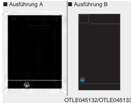
Diese Warnleuchte warnt den Fahrer vor einer möglicherweise vereisten Fahrbahn.
