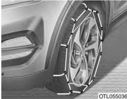
Da die Flanken von Radialreifen dünner sind als bei anderen Reifen, können sie durch bestimmte Schneeketten beschädigt werden. Deshalb empfehlen wir die Verwendung von Winterreifen anstelle von Schneeketten.
