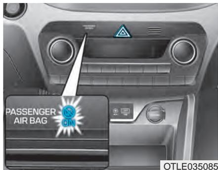
So reaktivieren Sie den vorderen Beifahrerairbag:
