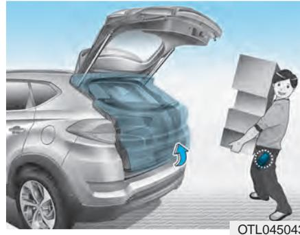
Bei Fahrzeugen mit Smartkey lässt sich die Heckklappe berührungslos über das Smartkey-Heckklappensystem öffnen.
