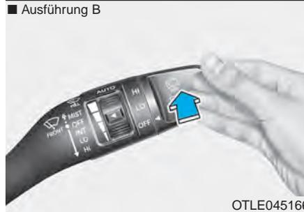
Drücken Sie den Hebel von sich weg, um Waschwasser auf die Heckscheibe zu sprühen und die Heckwischer 1 - 3 Zyklen wischen zu lassen.
