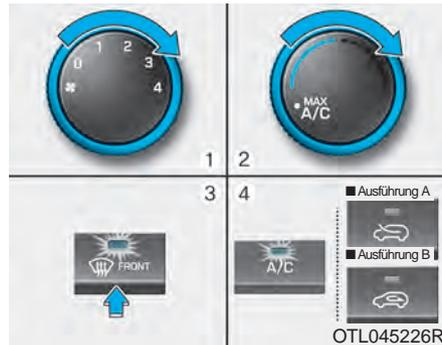
1. Drehen Sie den Gebläsedrehzahlregler in die höchste Stellung (ganz nach rechts).
