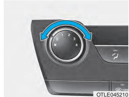
Das Gebläse kann nur bei eingeschalteter Zündung bedient werden.
