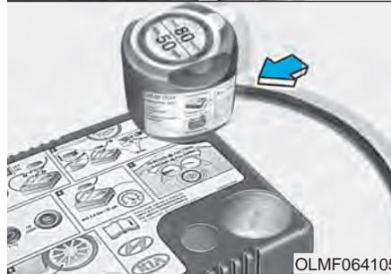
6. Vergewissern Sie sich, dass der Kompressor ausgeschaltet ist, Schalterstellung 0.
