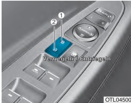
Wenn Sie den Bereich (🔒) (1) des Schalters drücken, werden alle Fahrertüren verriegelt.
