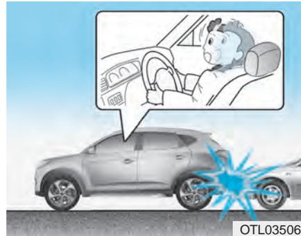
Die vorderen Airbags sollen sich nicht bei Heckkollisionen entfalten, da die Insassen durch einen Heckaufprall nach hinten bewegt werden. In diesem Fall bieten entfaltete Airbags keinen zusätzlichen Vorteil.
