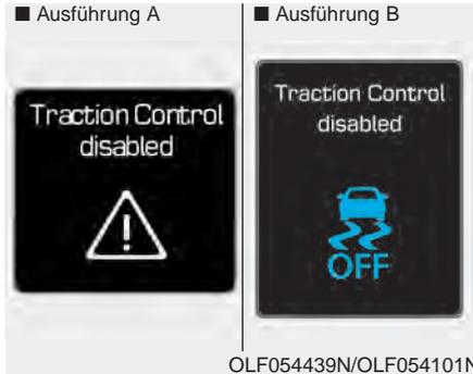
Drücken Sie kurz die Taste ESC OFF. (Daraufhin leuchtet die Kontrollleuchte ESC OFF auf und es erscheint eine diesbezügliche Meldung.) In diesem Zustand findet kein Eingriff in die Motorsteuerung statt. Die Traktionskontrolle ist nicht funktionsbereit, sondern es funktioniert nur die Bremsregelung.
