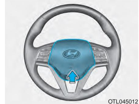
Um die Hupe zu betätigen, drücken Sie den mit dem Hupensymbol gekennzeichneten Bereich auf Ihrem Lenkrad (siehe Abbildung). Die Hupe ertönt nur, wenn Sie den gekennzeichneten Lenkradbereich drücken.
