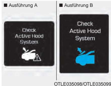
Die Warnmeldung erscheint auf dem LCD-Display, wenn eine Störung der Sicherheitsmotorhaube vorliegt.
