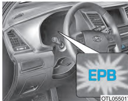
Wenn die EPB-Störungsanzeige nicht erlischt, beim Fahren aufleuchtet oder nicht aufleuchtet, wenn der Start/Stop-Knopf in die Stellung ON (EIN) wechselt, liegt möglicherweise eine Störung der elektrischen Feststellbremse vor.
