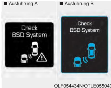
Bei einer Störung des Warnsystems „Toter Winkel“ (BSD) erscheint eine Warnmeldung und die Schalterleuchte erlischt. Das System schaltet sich automatisch ab. Wir empfehlen, das Fahrzeug in einer HYUNDAI Vertragswerkstatt inspizieren zu lassen.
