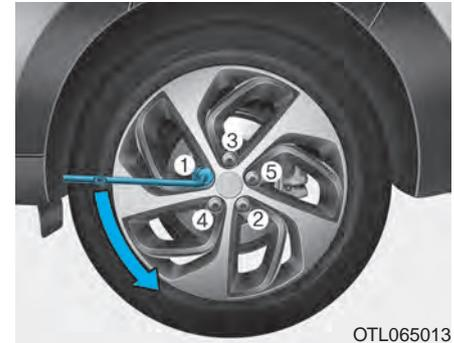
6. Lösen Sie die Radmutter in der gezeigten Reihenfolge um jeweils eine Umdrehung gegen den Uhrzeigersinn. Schrauben Sie sie aber erst dann ab, wenn das Rad nicht beim Anheben nicht mehr den Boden berührt.
