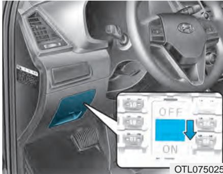
Lassen Sie den Sicherungs-Schalter stets in der Stellung ON (EIN).
