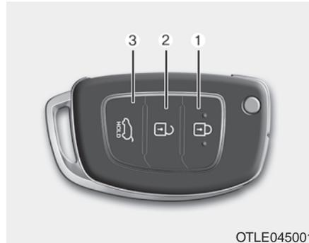
Zum Verriegeln der Türen drücken Sie die Türverriegelungstaste (1) auf dem Transponderschlüssel.
