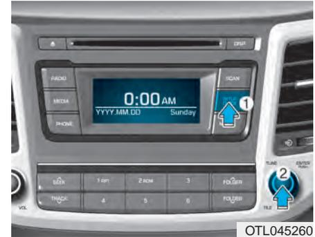
Nach jedem Abklemmen der Batterie und nach jeder Entnahme der entsprechenden Sicherung muss die Uhrzeit neu eingestellt werden.
