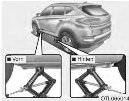
7. Setzen Sie den Wagenheber an dem dafür vorgesehenen Aufnahme- punkt an der Rahmen- unterseite an, der dem zu wechselnden Rad am nächsten ist. Die Aufnahme- punkte bestehen aus am Rahmen angeschweißten Blechen mit zwei Aussparungen und zwei Einbuchtungen. Heben Sie das Fahrzeug niemals an einer anderen Stelle an. Andernfalls wird möglicherweise das Dichtungsprofil beschädigt.
