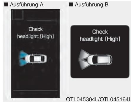
Diese Warnmeldung leuchtet auf, wenn eine Störung (durchgebrannte Glühlampe oder Stromkreisfehler) der Scheinwerfer vorliegt.
