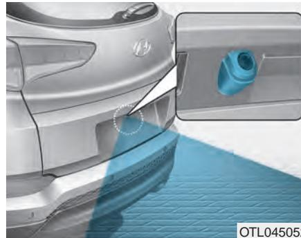
Die Rückfahrkamera wird aktiviert, wenn sich der Schalthebel bei laufendem Motor in der Stellung „R“ (Rückwärtsgang) befindet.
