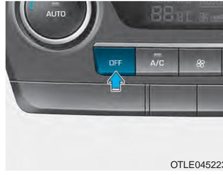
Zum Ausschalten der Klimaregelung drücken Sie vorn die Taste OFF (AUS). Die Modus- Taste und die Frischluft-/Umluftschaltung können jedoch weiterhin bedient werden, solange die Zündung eingeschaltet ist.
