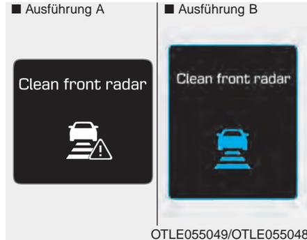
Wenn die Sensorabdeckung oder -linse verschmutzt ist (Schnee, Regen etc.), wird die AEB-Funktion möglicherweise vorübergehend eingestellt. In diesem Fall erscheint eine diesbezügliche Warnmeldung. Dabei handelt es sich nicht um eine Störung der AEB-Funktion. Um die die AEB-Funktion wieder in Betrieb zu nehmen, beseitigen Sie die Verschmutzung.
