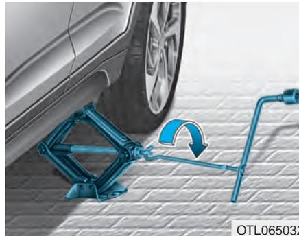
8. Führen Sie die Kurbel in den Wagenheber ein und drehen Sie sie gegen den Uhrzeigersinn, bis sich das Fahrzeug so weit hebt, dass das Rad nicht mehr den Boden berührt. Vergewissern Sie sich, dass das Fahrzeug fest auf dem Wagenheber ruht.
