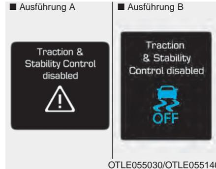
Drücken Sie mehr als drei Sekunden lang die Taste ESC OFF. Daraufhin leuchtet die Kontrollleuchte ESC OFF auf, was von einer Meldung und einem akustischen Warnsignal begleitet wird. In diesem Zustand findet kein Eingriff in die Motorsteuerung und die Bremsregelung statt. Es findet keinerlei Fahrzeugstabilitätskontrolle statt.
