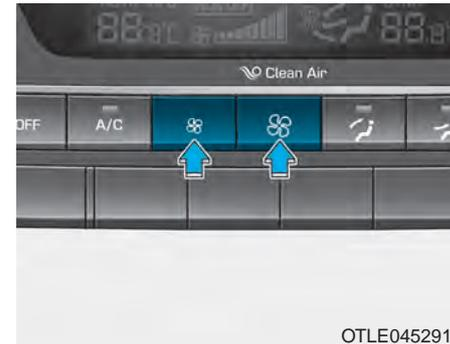
Durch Drücken des Geblüsedrehzahlreglers kann die gewünschte Geblüsedrehzahl eingestellt werden. Je höher die Geblüsedrehzahl, desto größer die zugeführte Luftmenge.
