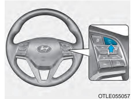
1. Drücken Sie die Lenkradtaste CRUISE
