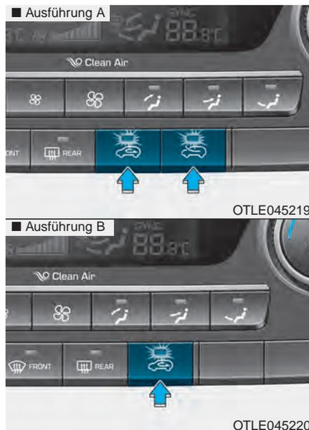
Mit dieser Schaltung können Sie zwischen der Zufuhr von Umgebungsluft (Frischlucht) und der Umwälzung der im Fahrzeug befindlichen Luft (Umluft) wählen.
