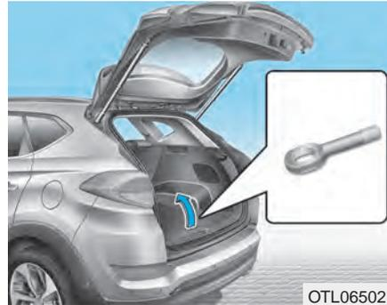
1. Öffnen Sie die Heckklappe und entnehmen Sie die Abschleppöse aus dem Werkzeugeinsatz.
