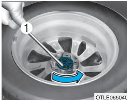
Wenn sich die Flügelschraube der Reserveradhalterung nicht von Hand lösen lässt, benutzen Sie zum Lösen die Wagenheberkurbel.
