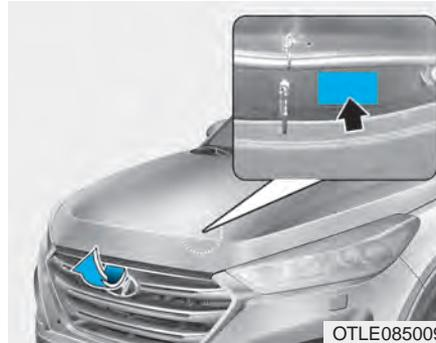
Der Kältemittelaufkleber enthält Angaben zu Typ und Menge des Kältemittels. Der Aufkleber befindet sich auf der Unterseite der Haube.
