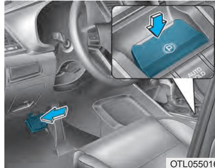
**Zum Lösen der Elektro Feststellbremse (EPB) drücken Sie unter den folgenden Bedingungen den EPB-Schalter:**
