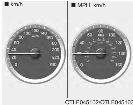
Der Tachometer zeigt die Fahrgeschwindigkeit in Kilometer pro Stunde (km/h) und/oder Meilen pro Stunde (MPH) an.
