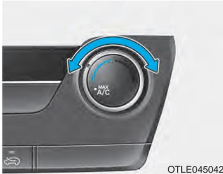
Mit diesem Drehknopf können Sie die Temperatur der aus den Luftdüsen strömenden Luft einstellen. Um die Temperatur im Fahrzeuginnenraum zu ändern, drehen Sie den Knopf nach rechts, um warme oder heiße Luft zu erhalten und drehen Sie ihn nach links, um kühlere Luft zu erhalten.
