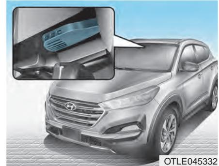
Die automatische Scheibenentfeuchtung verhindert das Beschlagen der Windschutzscheibe und misst automatisch deren Feuchtigkeit. Die automatische Scheibenentfeuchtung läuft bei eingeschalteter Klimaregelung.
