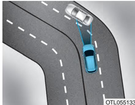
In Kurven erkennt das AEB möglicherweise vorausfahrende Fahrzeuge in der Nebenspur. Lassen Sie besondere Vorsicht walten und treten Sie ggf. das Bremspedal.
