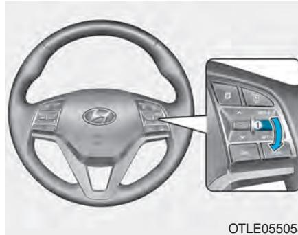
3. Drücken Sie den Hebel (1) nach unten (SET-) und lassen Sie ihn los. Daraufhin leuchtet die Kontrollleuchte SET auf.
