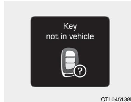
Diese Warnmeldung leuchtet auf, wenn sich der Smartkey nicht im Fahrzeug befindet, während Sie den Start/Stop-Knopf drücken. Sie bedeutet, dass Sie den Smartkey stets mit sich führen sollten.
