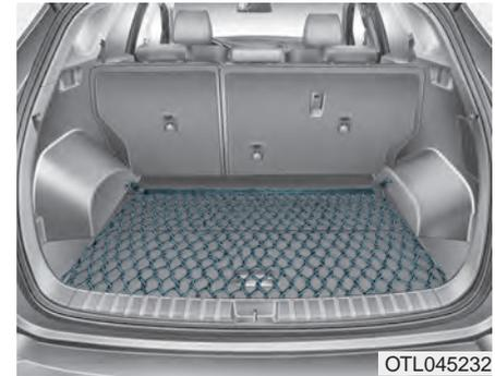
Um zu verhindern, dass sich das Ladegut unkontrolliert im Laderaum umherbewegen kann, können Sie die 4 Halter im Laderaum für die Befestigung eines Gepäcknetzes verwenden.
