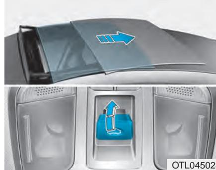
Wenn Sie den Schiebedachregler bis zur zweiten Raste nach hinten ziehen, öffnet sich zunächst die Sonnenblende und dann das Schiebedach komplett. Um die Schiebedachbewegung an einem beliebigen Punkt anzuhalten, ziehen oder drücken Sie kurz den Schiebedachregler.
