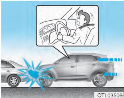
Bei bestimmten Kollisionen mit geringer Geschwindigkeit ist es möglich, dass Airbags nicht ausgelöst werden. Airbags sind so konzipiert, dass sie in solchen Fällen nicht ausgelöst werden, da sie unter diesen Umständen die Schutzwirkung der Sicherheitsgurte nicht verbessern können.
