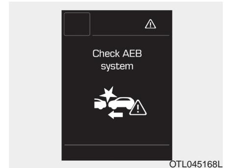
Diese Warnmeldung leuchtet auf, wenn eine Störung der AEB-Funktion (Autonomous Emergency Braking) vorliegt. Wir empfehlen, das Fahrzeug in einer HYUNDAI Vertragswerkstatt überprüfen zu lassen.
