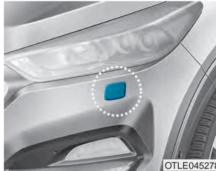
Unter den folgenden Bedingungen wird gleichzeitig mit dem Betrieb der Frontscheibenwaschanlage Waschflüssigkeit auf die Scheinwerfer gesprüht:
