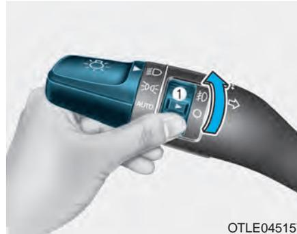
Nebelscheinwerfer sollen die Sicht verbessern, wenn sie durch Nebel, Regen, Schnee etc. eingeschränkt ist. Benutzen Sie zum Einschalten der Nebelscheinwerfer den neben dem Lichtschalter befindlichen Schalter.
