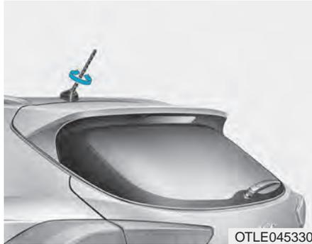
Die Dachantenne empfängt sowohl AM- als auch FM-Rundfunksignale. Drehen Sie den Dachantenne zum Abnehmen gegen den Uhrzeigersinn. Drehen Sie sie im Uhrzeigersinn, um sie wieder anzubringen.
