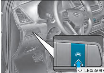
Der Spurhalteassistent erkennt Fahrspurmarkierungen und hilft dem Fahrer dabei, das Fahrzeug in der Spur zu halten.
