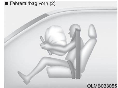
Bei der Auslösung trennen sich Sollrissnähte, die direkt in die Verkleidungen eingearbeitet sind, unter dem Druck der Airbagausdehnung. Die daraufhin entstehenden Öffnungen in den Abdeckungen erlauben die vollständige Ausdehnung der Airbags.
