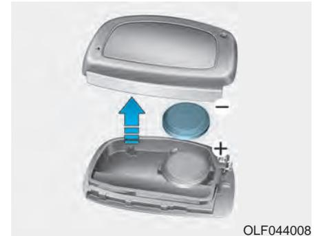
Wenn der Smartkey nicht ordnungsgemäß funktioniert, tauschen Sie versuchsweise die Batterie aus.
