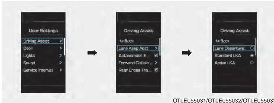
Im Modus „Benutzereinstellungen“ des LCD-Displays kann der Fahrer vom Spurhalteassistenten zum Spurhaltewarnsystem umschalten oder zwischen den Betriebsarten „Standard-LKA“ und „Aktiv-LKA“ wechseln. Wenn keine Funktion ausgewählt wird, befindet sich das System automatisch im Modus „Standard-LKA“.
