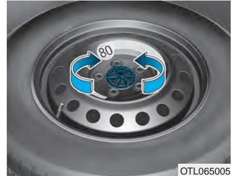
Drehen Sie die Flügelschraube gegen den Uhrzeigersinn, um das Reserverad zu entnehmen.
