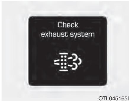
Diese Warnmeldung leuchtet auf, wenn eine Störung der DPF-Funktion vorliegt. Gleichzeitig blinkt die DPF-Warnleuchte.
