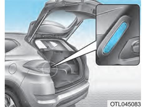
Die Gepäckraumleuchte leuchtet auf, wenn die Heckklappe geöffnet wird.
