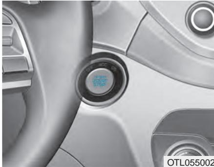
Beim Öffnen der vorderen Tür leuchtet der Start/Stop-Knopf auf. Er erlischt 30 Sekunden nach dem Schließen der Tür.
