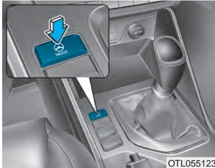
Das Flex-Lenkrad regelt den Lenkwiderstand abhängig vom Fahrbahnzustand und von den Wünschen des Fahrers.
