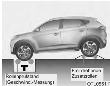
Ein Fahrzeug mit permanentem Allradantrieb kann nicht auf einem Rollenprüfstand für 2WD-Fahrzeuge geprüft werden. Wenn ein 2WD-Rollenprüfstand benutzt werden muss, gehen Sie wie folgt vor:
