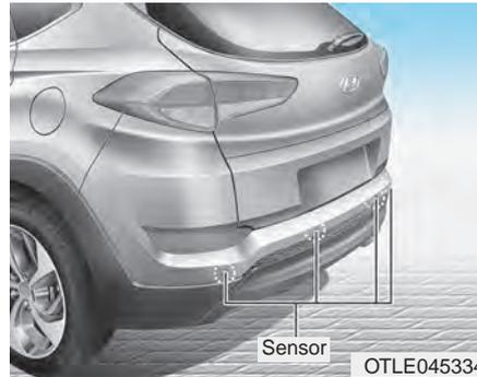
Der Parkassistent unterstützt den Fahrer beim Rückwärtsfahren, indem er ein akustisches Signal ertönen lässt, wenn hinter dem Fahrzeug ein Hindernis erkannt wird, dessen Abstand zum Fahrzeug max. 1,20 Meter beträgt.
