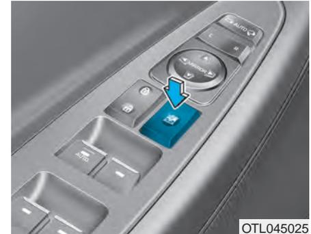
Der Fahrer kann die elektrischen Fensterheber der hinteren Türen deaktivieren, indem er die Fensterhebersperrtaste drückt.
