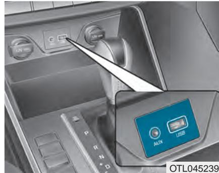
Über die AUX-Schnittstelle können Audiogeräte angeschlossen werden, während die USB-Schnittstelle für USB-Datenträger vorgesehen und die iPod®-Schnittstelle für iPod®-Geräte reserviert ist.
