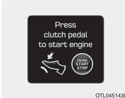
Diese Warnmeldung leuchtet auf, wenn der Start/Stop-Knopf zwei Mal in die Stellung ACC wechselt, weil der Knopf wiederholt gedrückt wird, ohne das Kupplungspedal zu treten. Depress the clutch pedal to start the engine (Zum Anlassen Kupplung treten).
