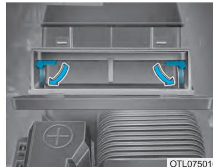
3. Ziehen Sie den Hebel nach unten in die Stellung UNLOCK.
