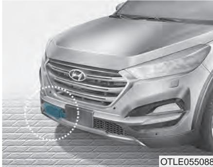
Der Sensor soll für die Einhaltung eines bestimmten Abstands zum vorausfahrenden Fahrzeug sorgen. Wenn der Sensor allerdings verschmutzt ist (Schnee, Regen etc.), beeinträchtigt dies die Erkennungsleistung. Die AEB-Funktion kann dadurch sogar vorübergehend eingestellt werden. Halten Sie die Sensorlinse stets sauber.
