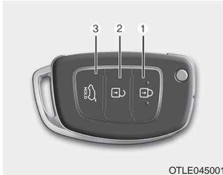
Ihr HYUNDAI ist mit einem Transponderschlüssel ausgestattet, mit dem Sie die Türen (und die Heckklappe) ver- und entriegeln und auch den Motor starten können.
