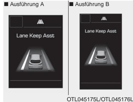
In diesem Modus wird der Zustand des Spurhalteassistenten LKAS angezeigt.
