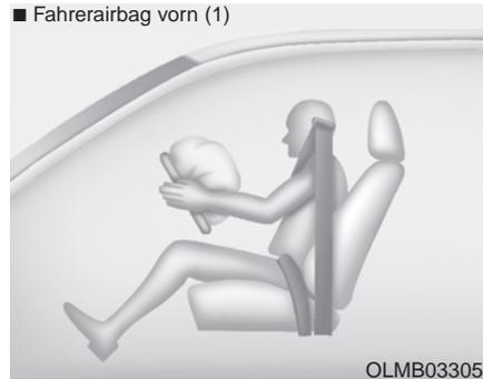
Wenn das SRSSteuermodul einen ausreichend schweren Aufprall an der Fahrzeugfront erkennt, löst es automatisch die vorderen Airbags aus.
