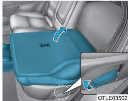
5. Um den Rücksitz in Gebrauch zu nehmen, heben und drücken Sie die Sitzlehne nach hinten, indem Sie den vorderen Teil des Umklapphebels nach oben ziehen.
