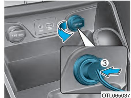
7. Verbinden Sie den Kompressor und die Batterie mit dem Kabel und den Steckern.
