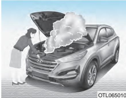
Wenn die Kühlmitteltemperaturanzeige eine Überhitzung anzeigt, die Leistung nachlässt oder laute Klopf- oder Klingelgeräusche hörbar sind, ist möglicherweise der Motor überhitzt. Ergreifen Sie in diesem Fall folgende Maßnahmen:
