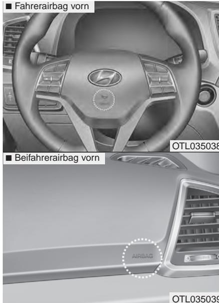
Ihr Fahrzeug ist mit einem ergänzenden Rückhaltesystem (SRS, Supplemental Restraint System) und Dreipunktgurten für Fahrer- und Beifahrersitz ausgestattet.
