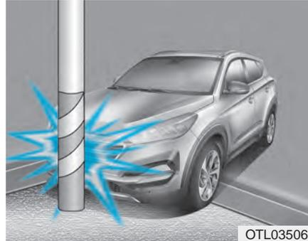
Es kann vorkommen, dass Airbags nicht entfaltet werden, wenn das Fahrzeug mit Masten oder Bäumen etc. kollidiert, wobei sich der Aufprallpunkt auf einen schmalen Bereich konzentriert und die Aufprallenergie von der Knautschzone absorbiert wird.
