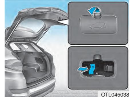
Ihr Fahrzeug ist mit einem Hebel für die Notentriegelung der Heckklappe ausgerüstet.
