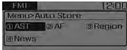
Wählen Sie AST (Automatische Speicherung), um auf den Speicherpositionen **1** ~ **6** Sender mit besonders hoher Empfangsqualität zu speichern. Falls keine Frequenzen empfangen werden, wird der zuletzt empfangene Sender gespeichert.
