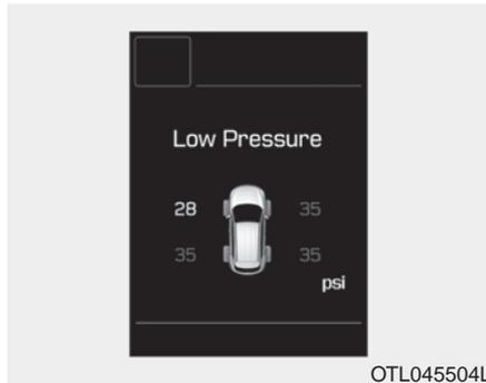
Diese Warnmeldung leuchtet auf, wenn der Reifenluftdruck zu gering ist, während sich der Zündschalter in der Stellung ON (EIN) befindet.
