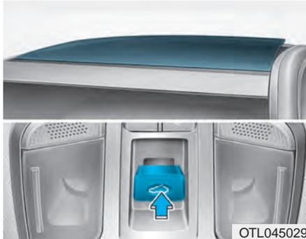
Wenn Sie den Schiebedachregler nach oben drücken, öffnet sich zunächst die Sonnenblende und anschließend stellt sich das Schiebedach auf.
