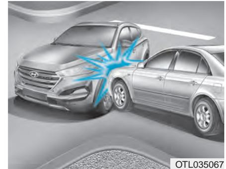
Die vorderen Airbags werden bei seitlichen Kollisionen möglicherweise nicht ausgelöst, da sich die Insassen in die Richtung Aufprallseite bewegen, wobei entfaltete vordere Airbags keinen zusätzlichen Insassenschutz bieten.
