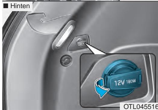
Die 12V-Steckdosen sind für die Stromversorgung von Mobiltelefonen und anderen Geräten, die mit der Bordspannung des Fahrzeugs betrieben werden können, vorgesehen.
