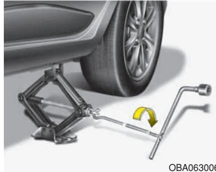
8. Setzen Sie die Wagenheberkurbel am Wagenheber ein, drehen Sie mit der Kurbel im Uhrzeigersinn und heben Sie das Fahrzeug so hoch, dass das Rad knapp über dem Boden ist. Das entspricht ungefähr 30 mm. Bevor Sie die Radmuttern entfernen, versichern Sie sich, dass das Fahrzeug stabil ist und keine Möglichkeit besteht, dass es sich bewegen oder verschieben kann.
