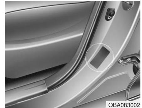
Die Fahrzeugidentifikationsnummer (VIN) befindet sich auf dem Fahrzeugzertifizierungsaufkleber an der B-Säule auf der Fahrerseite (oder Beifahrerseite).
