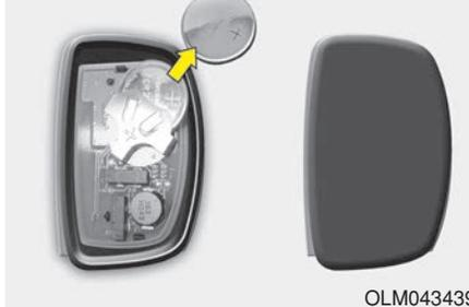
2. Ersetzen Sie die Batterie durch eine neue. Beim Auswechseln stellen Sie sicher, dass der positive Pol der Batterie "+" gemäß der Bezeichnung im Batteriegehäuse eingesetzt wird.
