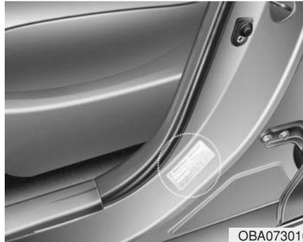
Alle Angaben (Größen und Druckwerte) sind auf einem Etikett an der Fahrer- oder Beifahrertür angegeben.
