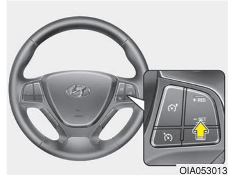
3. Drücken Sie den SET Schalter, und fahren Sie die gewünschte Geschwindigkeit. Das Reisegeschwindigkeit Anzeigelicht auf der Instrumententafel wird angezeigt. Zur selben Zeit Fuß vom Gaspedal wegnehmen. Die gewünschte Geschwindigkeit wird automatisch gehalten.
