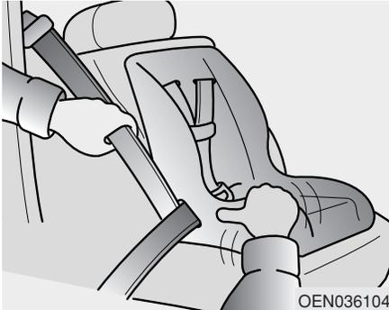
3. Spannen Sie den Riemen so weit wie möglich durch Herunterdrücken des Kindersitzes, wenn der Schultergurt eingerastet wird.
