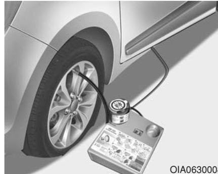
5. Prüfen Sie, dass der Kompressor in Stellung 0 abgeschaltet ist.
