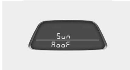
Wenn der Fahrer den Zündschlüssel entfernt (der Smartschlüssel schaltet den Motor aus) und die Fahrertür öffnet und das Schiebedach nicht ganz geschlossen ist, ertönt die Warnmelodie und Schiebedach-Warnleuchte leuchtet oder blinkt.
