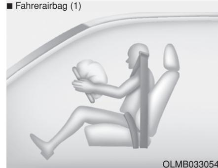
Wird durch das Airbag-Steuermodul festgestellt, dass ein Aufprall stark genug war, lösen die vorderen Airbags augenblicklich aus.
