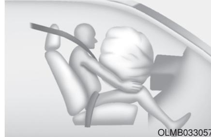
Nach der vollständigen Ausdehnung lässt der Airbag seinen Druck sofort wieder ab und ermöglicht dem Fahrer freie Sicht nach vorne, um das Fahrzeug sicher zu lenken.
