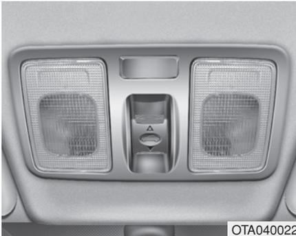
Wenn Ihr Fahrzeug mit einem Schiebedach ausgestattet ist, Sie gleiten kann oder neigen Sie Schiebedach mit Schiebedach Steuerhebel in der Dachkonsole öffnen oder schließen.
