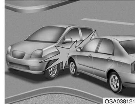
Die vorderen Airbags lösen nicht zwingend bei einem seitlichen Aufprall aus, da die Insassen in die Richtung des Aufpralls und die Seitenairbags gedrückt werden und daher die vorderen Airbags keinen zusätzlichen Schutz bieten.
