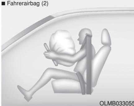
Während der des Auslösens öffnen sich unter dem Druck der Airbagausdehnung die Solltrennstellen innerhalb der Abdeckung. Damit kann sich der Airbag voll aufblasen.
