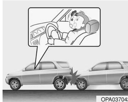
Die vorderen Airbags wurden so konstruiert, dass sie bei einem Auffahrunfall nicht auslösen, da die Insassen durch die Wucht des Aufpralls im Sitz nach hinten gedrückt werden. In einem solchen Fall würden die Airbags keinen zusätzlichen Schutz bieten.
