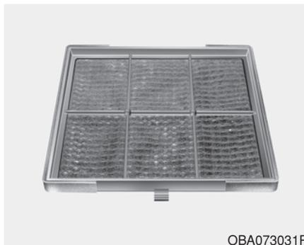
4. Prüfen und reinigen Sie das Filter des Klimasteuerung mit Wasser.
